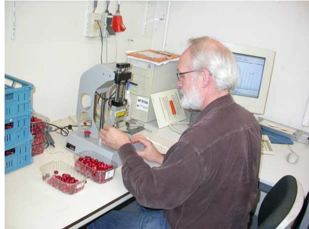
Foto 5: Hardheidsmeting met de FTA
