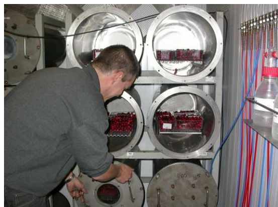
Foto 1: Het doorstroomsysteem voor het aanleggen van de verschillende gascondities.
